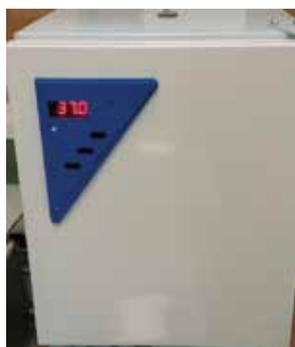
**Рис. 6.** Термостат сухо-воздушный ТВ-20-ПЗ-К
